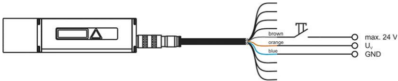
Abbildung 22 : Beschaltung Triggereingang
